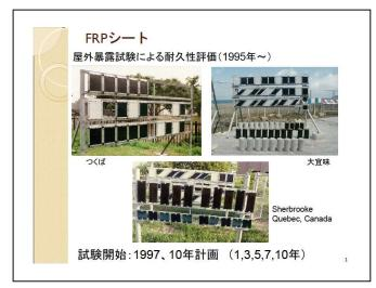
ケーブルについて研究していましたが、耐久性について屋外暴露試験を実施していました。 駿河湾に試験施設があり腐食環境が厳しいところで緊張したまま暴露試験を行い、強度が どのように変化するかなどを検討したことから、FRP シートについても同様の暴露試験が 良いと考えました。私が滞在したカナダのシェルブルックは非常に寒いところで、環境も 日本とかなり異なるので、カナダと日本の両方で暴露試験を実施すれば、世界中の様々な 環境での FRP の耐久性に役立つデータが得られると考えました。そこでシェルブルック大 学構内に暴露場を作ってもらって暴露試験を行うとともに、日本でも、土研の暴露場のあ るつくばと沖縄にも同様の試験を行うこととしました。カナダは北緯 45 度・平均気温 4 度、 日本ではつくばは北緯 35 度・平均気温 14 度、また沖縄は北緯 26 度・平均気温 22 度で、 緯度は 10 度ずつ平均気温も 10 度ずつ差があるので、特徴的な暴露環境であったと思いま す。
